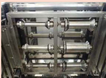
Kabel/Draht-Wickelzubehör für die 'Kaltbiegeprüfung'.
